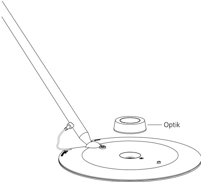
Das breitstrahlende Licht des Leuchtenkopfes ohne Optik mit 120° kann durch aufgesetzte Optike gebündelt werden.
